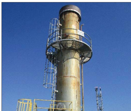
ภาพถ่ายที่ 2.2-13 Thermal Oxidizer (TOX)
